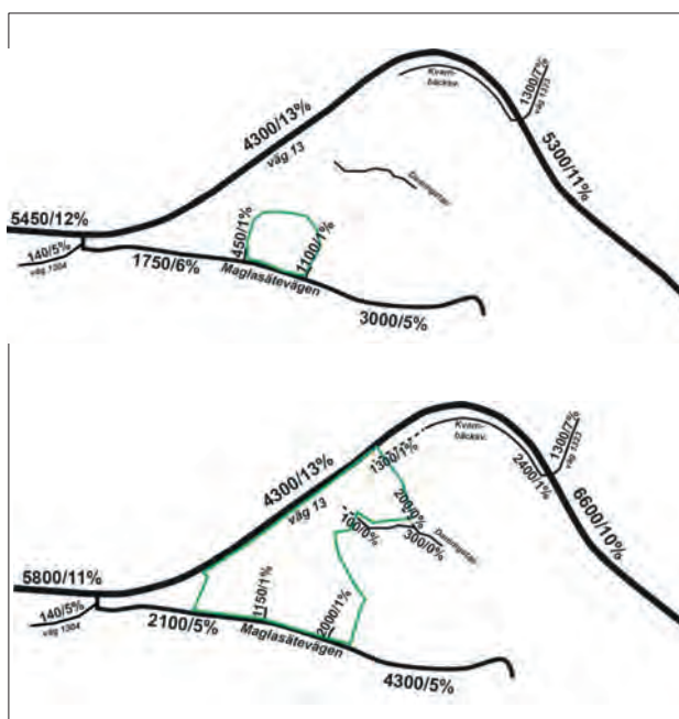
Figur 17. När denna och den första detaljplanen, etapp 1 inom stadsdelen (grön väg-slinga markerad runt kvarteret) är utbyggt ansluter all trafik från Maglasätevägen i söder. Trafikmängderna som alstras inom detaljplanerna har lagts till det övergripande trafiknätet och fördelningen är gjord efter grundprincipen kortast/snabbast väg. (Tyréns AB, Trafikutredning 2018-07-13 rev 2020-07-05, sid 11).
