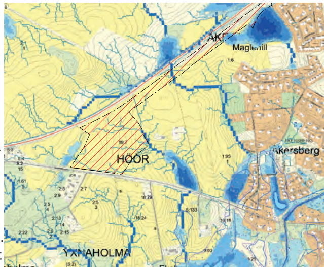
Figur 11. Utdrag ur Länsstyrelsens skyfallskartering som visar vattnets beräknade rinnvägar och lågpunkter.
